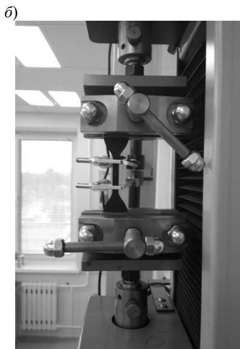
Рис. 2. Применяемое оборудование: а – 3D-принтер VSHAPER PRO; б – испытательная машина Kason WDW-1
