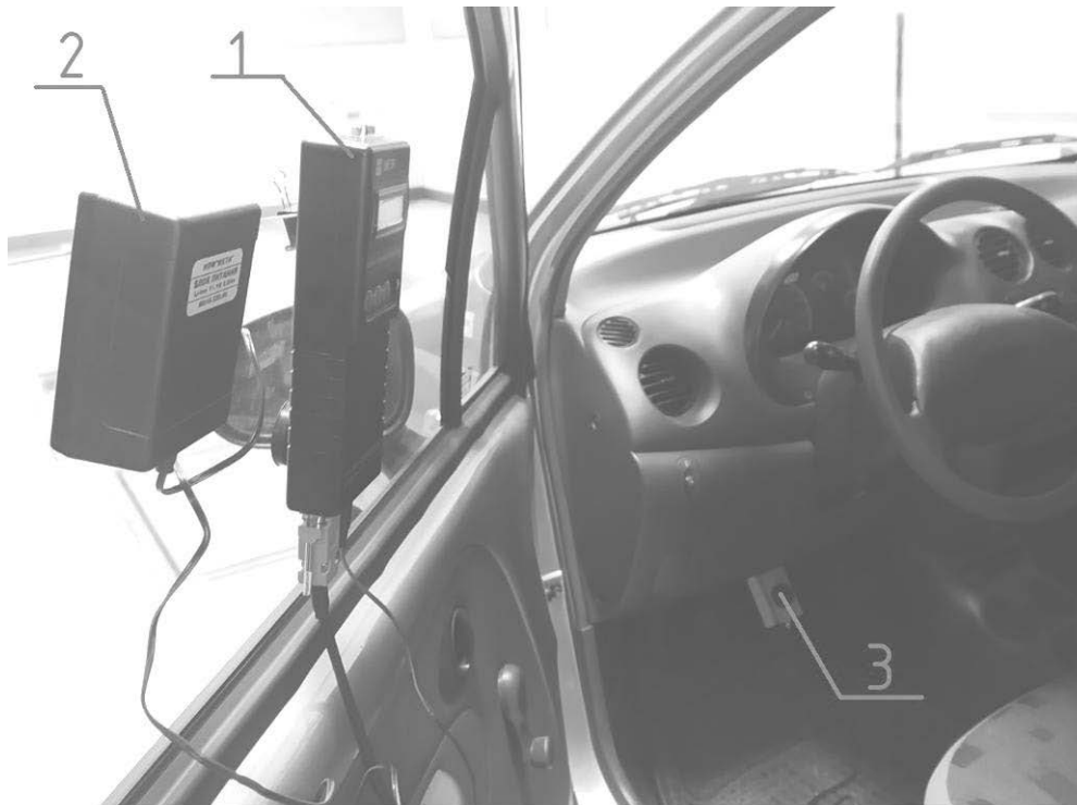
Рис. 5. Расположение измерительного прибора «Эффект-02» на автомобиле Daewoo Matiz: 1 – измерительный блок прибора «Эффект-02»; 2 – независимый источник питания прибора; 3 – датчик измерения момента и усилия нажатия на педаль тормоза
