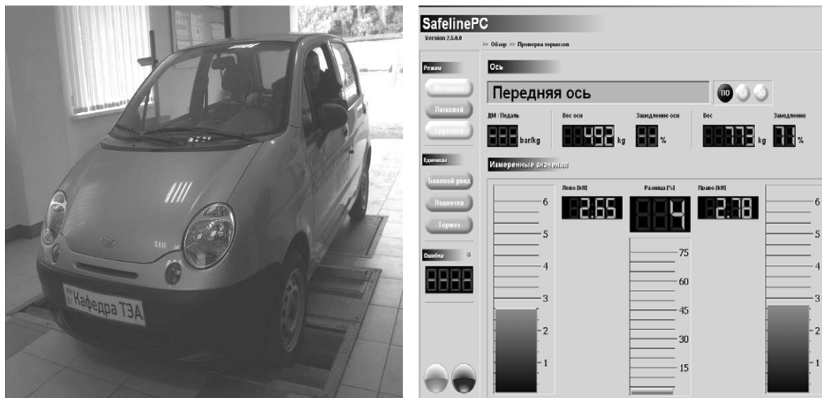
Рис. 2. Автомобиль Daewoo Matiz на роликовом силовом стенде диагностической линии Sherpa Autodiagnostik AST-10,0-Top и результаты измерений работы тормозных механизмов передней оси
