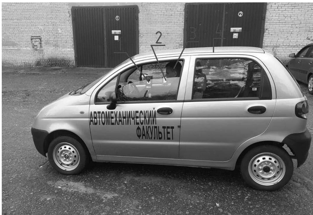
Рис. 7. Автомобиль Daewoo Matiz, подготовленный к проведению дорожных испытаний эффективности работы тормозной системы на учебно-лабораторном полигоне кафедры «Техническая эксплуатация автомобилей» Белорусско-Российского университета: 1 – прибор «Эффект-02»; 2 – АКБ прибора «Эффект-02»; 3 – водитель-испытатель; 4 – автомобиль Daewoo Matiz
