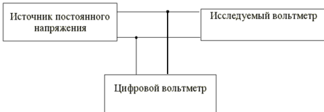
Рисунок 1.1 – Схема для исследования погрешностей вольтметра
