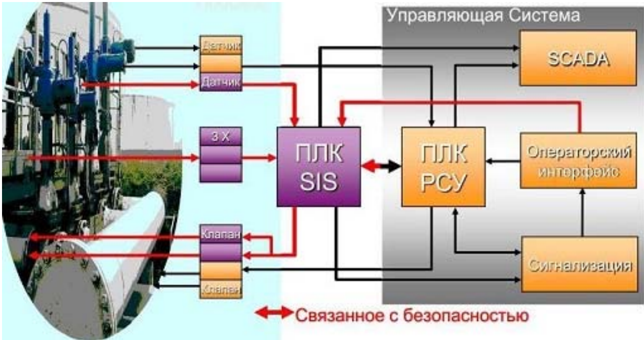
Рисунок 3.3 – Архитектура средств PCY (BPCS) + ПАЗ(SIS)
