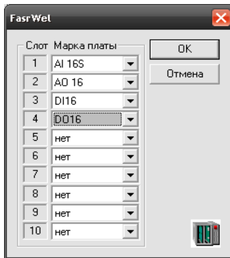
Рисунок 4.7 – Настройка процедуры автопостроения базы каналов
