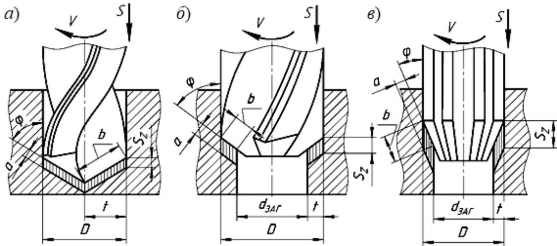
Рисунок 4.1 – Схемы процессов сверления (а), зенкерования (б) и развертывания (в)
