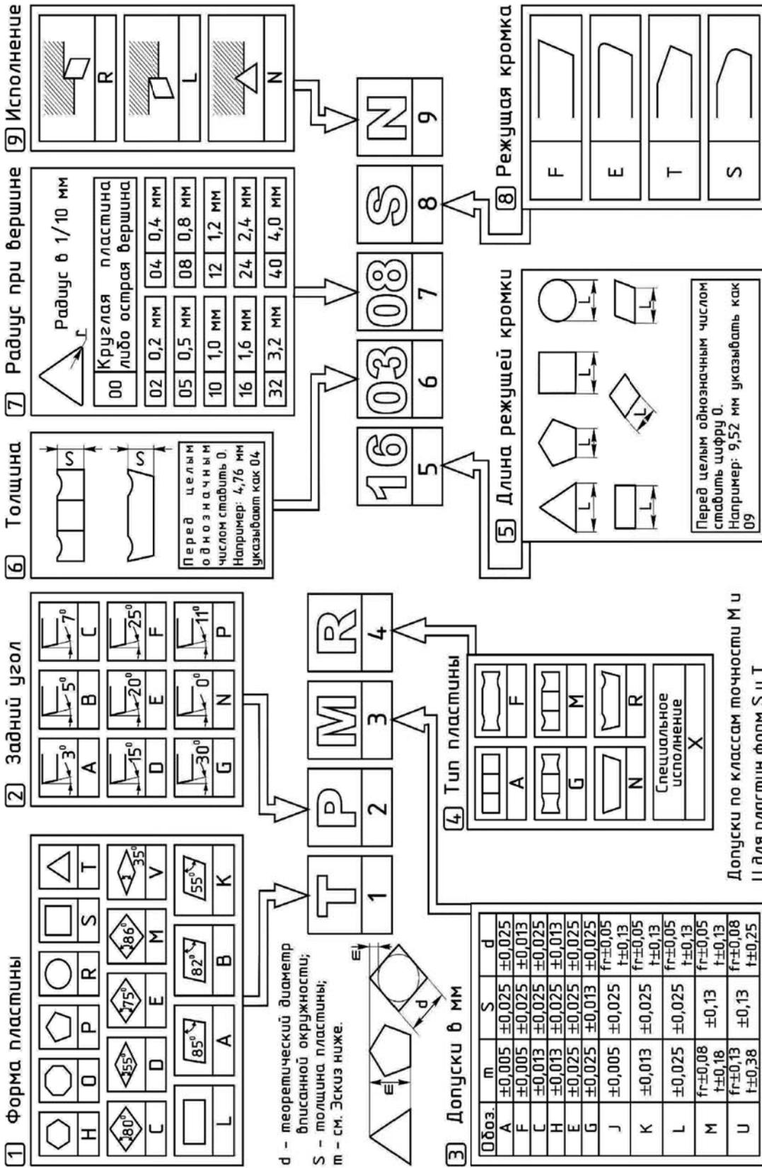
Рисунок 1.3 – Кодировка многогранных неперетачиваемых пластин в системе ISO 1832:1999
