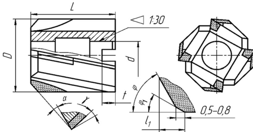
Рисунок 4.9 – Насадной зенкер с напайными пластинками твердого сплава
