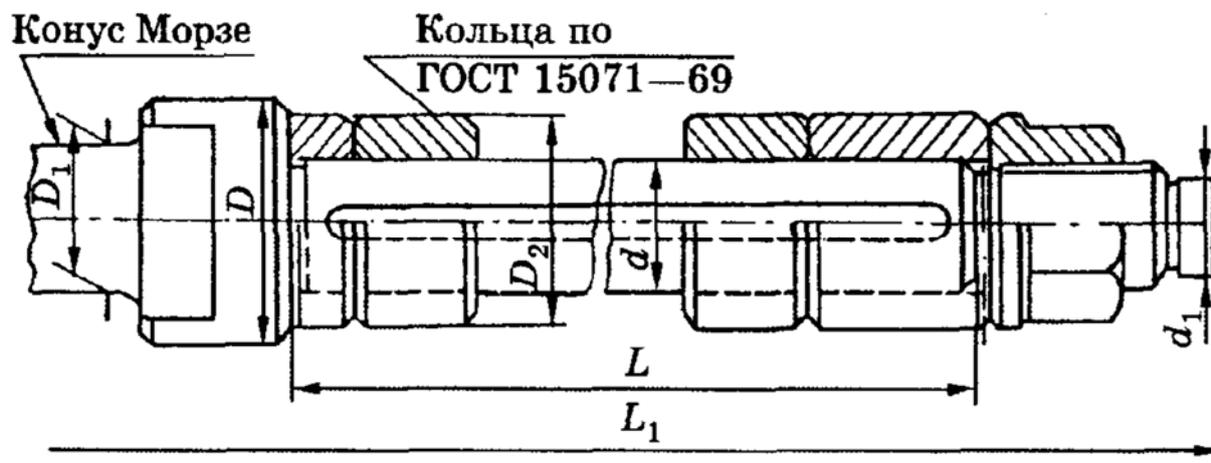
Рисунок 3.1 – Оправка для крепления дисковых и цилиндрических фрез с передачей крутящего момента при помощи продольной шпонки
