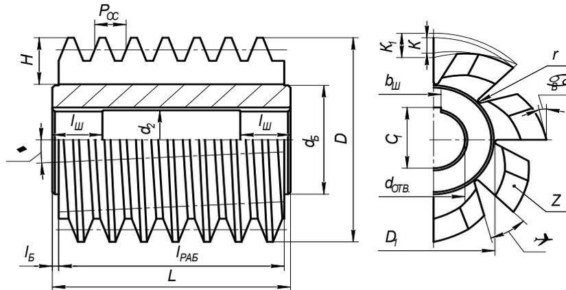
Рисунок 7.5 – Червячная модульная фреза
