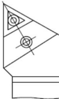
7 Типовое обозначение поворотной пластины в ISO.
