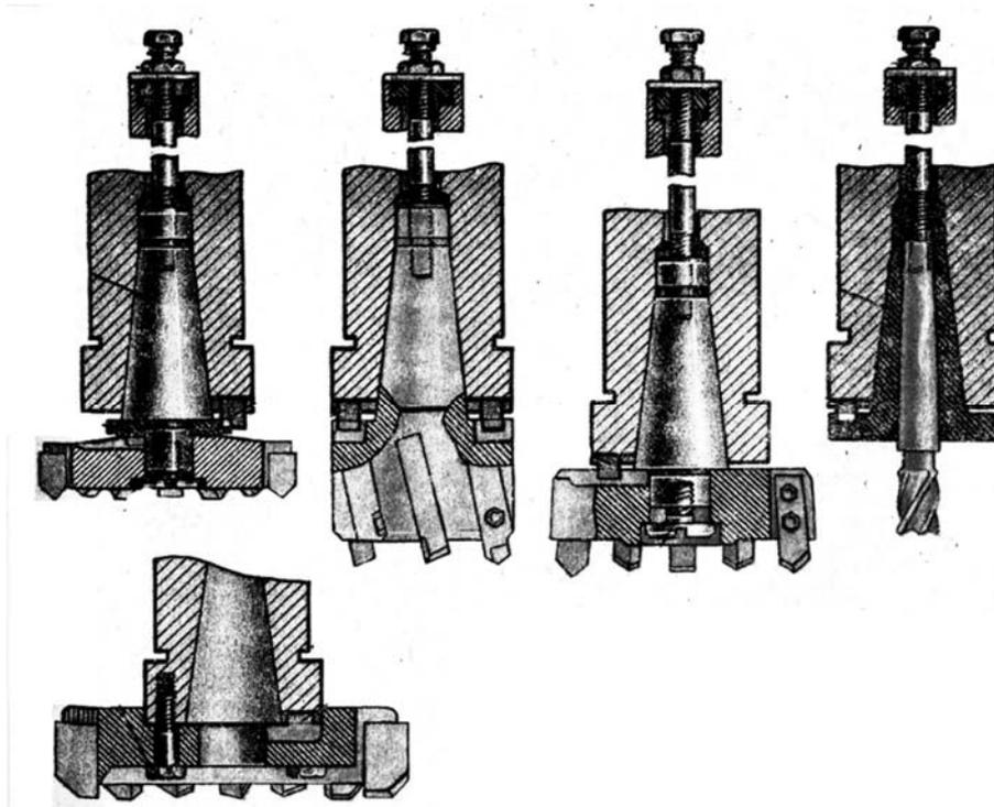
Рисунок 3.2 – Установка и закрепление торцовых и концевых фрез
