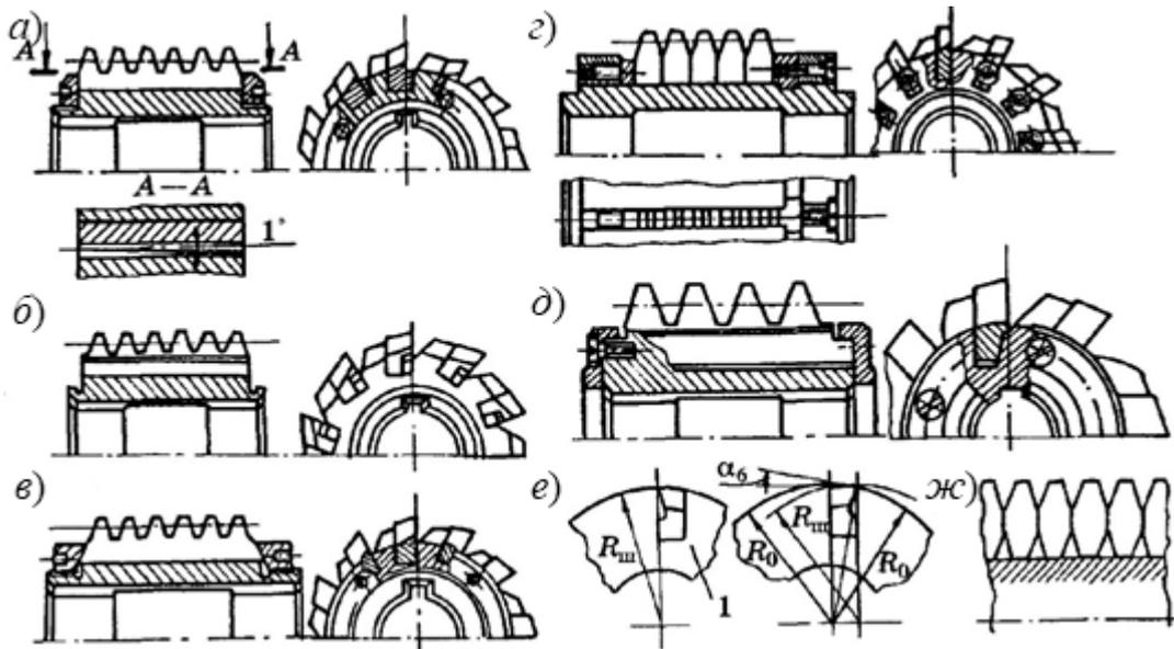
*a, б* – крепление реек клиньями; *в* – крепление реек гайками; *г* – крепление отдельных зубьев винтами; *д* – крепление реек крышками; *е* – образование заднего угла круглым шлифованием; *ж* – фрагмент фрезы с МНП
