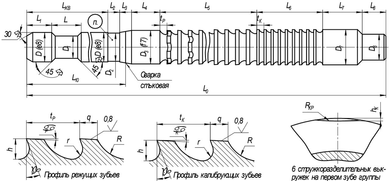
Рисунок 2.1 – Протяжка для обработки цилиндрического отверстия
