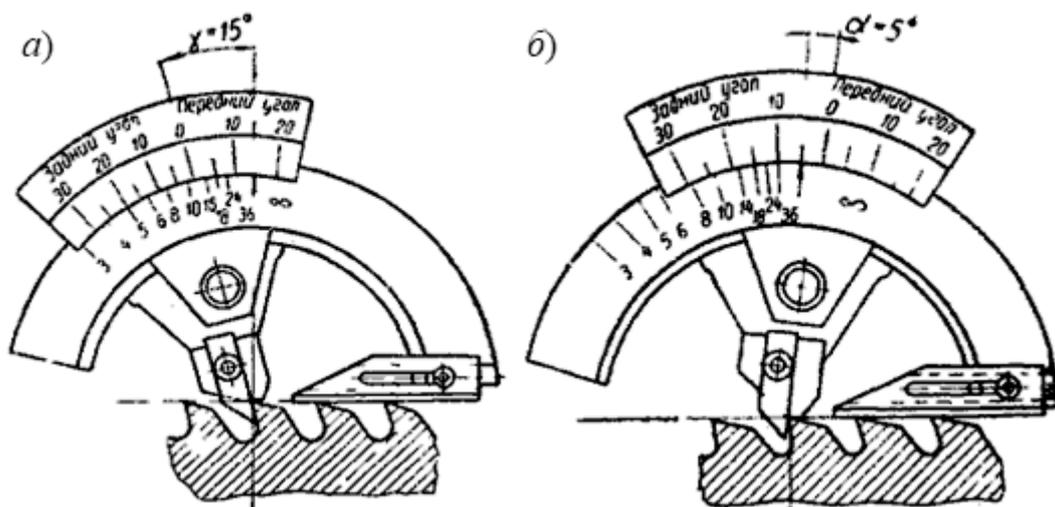
Рисунок 2.3 – Измерение геометрических параметров протяжки
