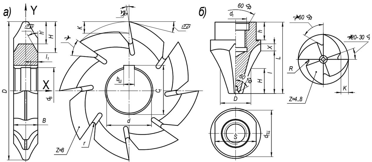
Рисунок 7.1 – Дисковые (а) и пальцевые (б) модульные фрезы
