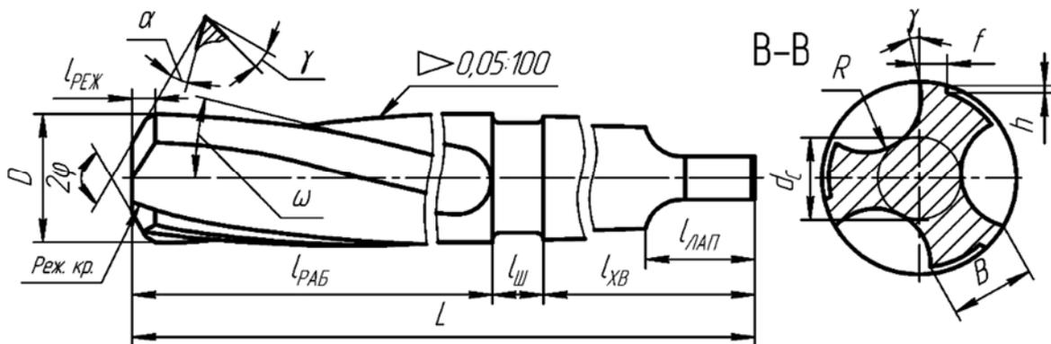
Рисунок 4.5 – Концевой цилиндрический зенкер
