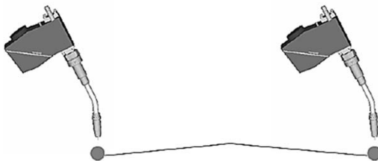
Рисунок 11.1 – Перемещение сварочной горелки из точки в точку при кусочной интерполяции
