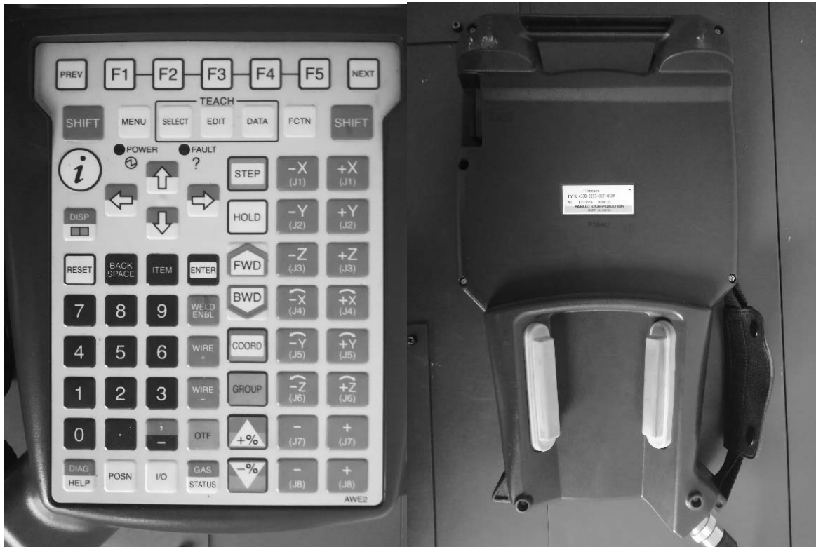
Рисунок 5.2 – Лицевая (без дисплея) (а) и обратная (б) стороны пульта
