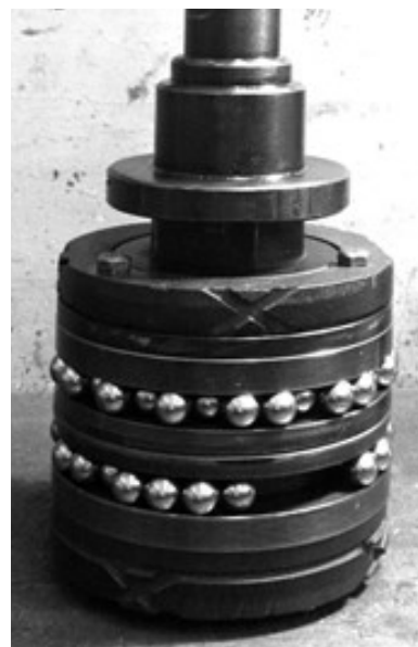
Рис. 1. Упрощенная схема и фото двухрядного шарикового накатника пневмоцентробежного действия
