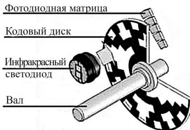
Рисунок 2.3 – Устройство однооборотного энкодера
