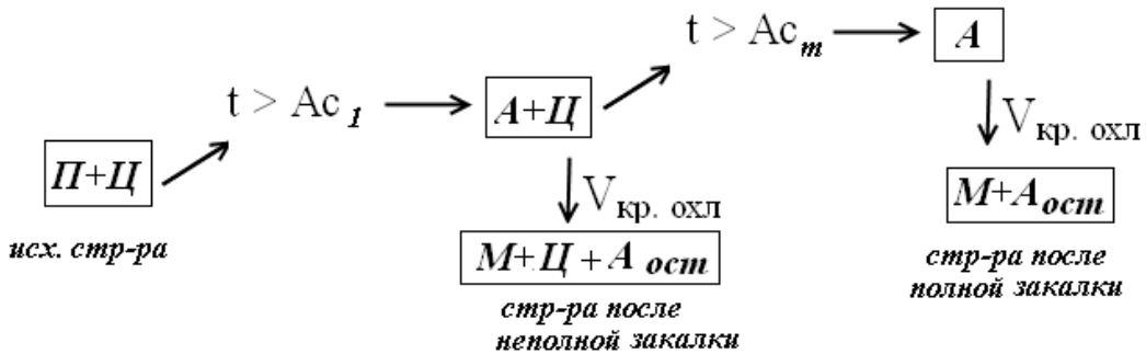
Рисунок 8.5 – Схема структурных изменений при закалке заэвтектоидных сталей
