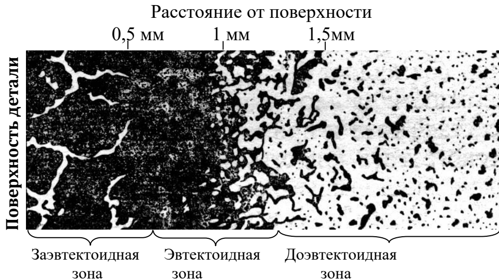
Рисунок 11.1 – Микроструктура поверхностной зоны стали, подвергнутой цементации
