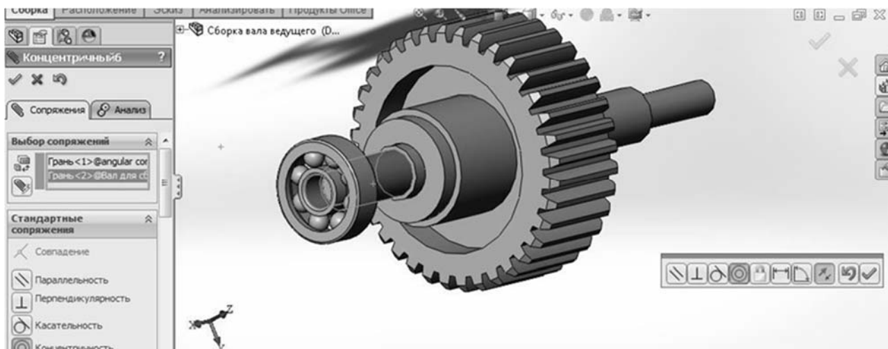
Рисунок 4.3 – Установка подшипника на вал
