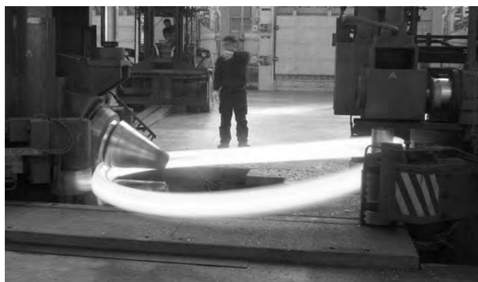
Рис. 1. Искажение малогабаритного кольца при кольцераскатке
