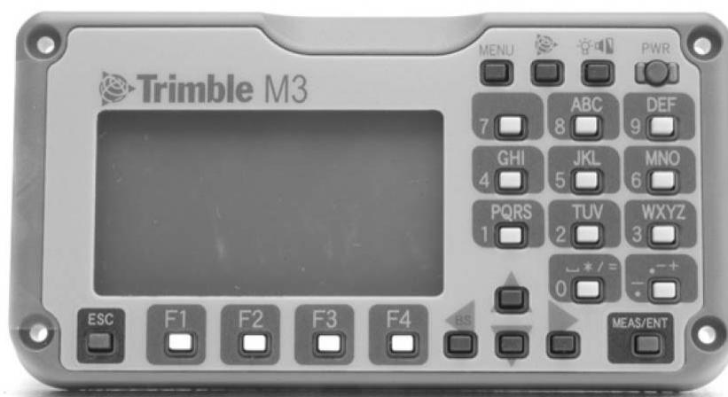
Рисунок 7.3 – Жидкокристаллический экран и клавиатура Trimble M3
