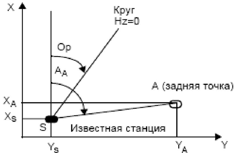
Рисунок 7.6 – Установка известной станции
