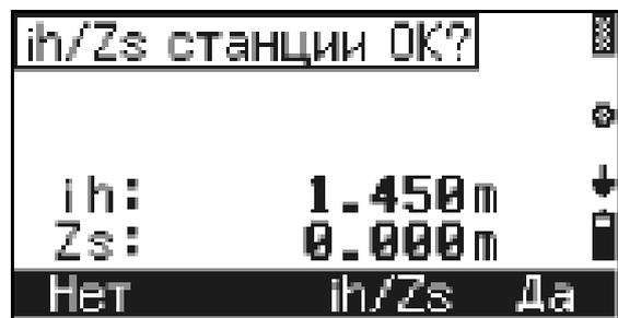
Рисунок 7.20 – Высота станции
