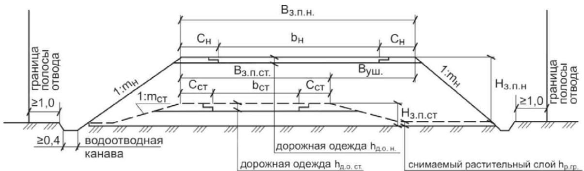
Рисунок 7.1 – Реконструкция земляного полотна с увеличением высоты и ширины насыпи
