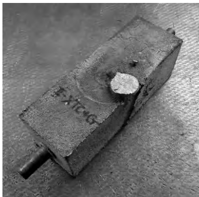
Рис. 1. Деталь «Вкладыш отбойный» со стальным стержнем-охладителем (а) и без него (б)
