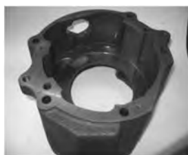
Рис. 1. Корпус тормоза трактора «Беларус» (а) и зона упрочнения (б)
