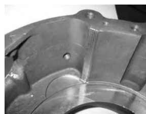
Рис. 1. Корпус тормоза трактора «Беларус» (а) и зона упрочнения (б)
