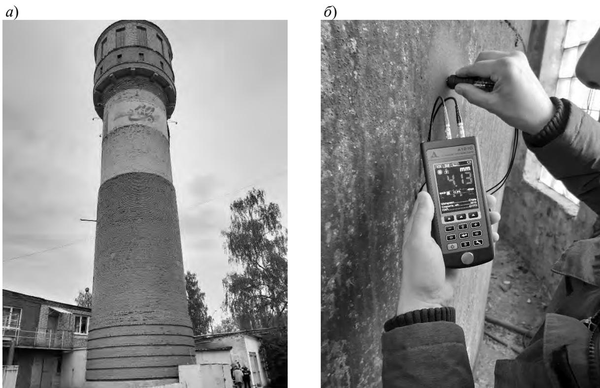
Рис. 1. Обследуемая водонапорная башня: *а* – вид на обследуемую водонапорную башню; *б* – определение фактической толщины стенок резервуаров (баков) обследуемой водонапорной башни ультразвуковым толщиномером А1210
