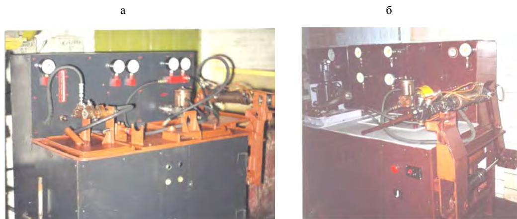
Рис. 2. Стенды для общего и поэлементного испытаний гидроусилителей рулевого управления: а – стенд в МГКУП «Горэлектротранспорт» (г. Могилев); б – стенд в УКПП «Бобруйское троллейбусное управление»
