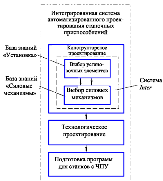
Рис. 6. Применение системы Inter в интегрированных системах автоматизированного проектирования станочных приспособлений
