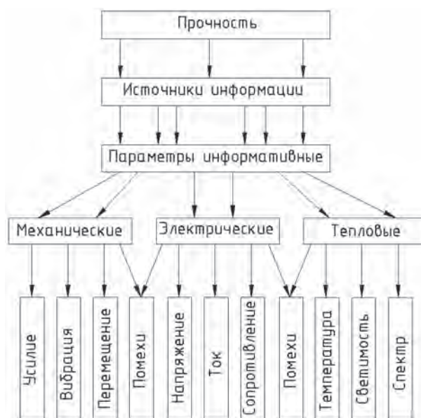
Рис. 3. Схема распределения информационных операций по контролю качества сварки
