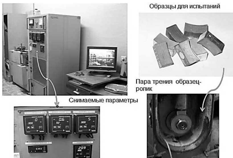
Рисунок 4.6 – Модернизированная установка для испытаний на износ
