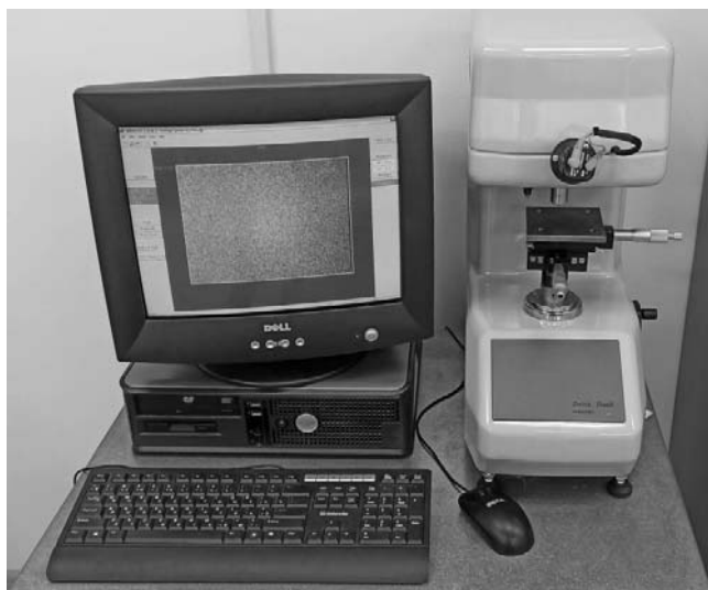
Рисунок 4.3 – Твердомер Zwick Roell ZHV 1M
