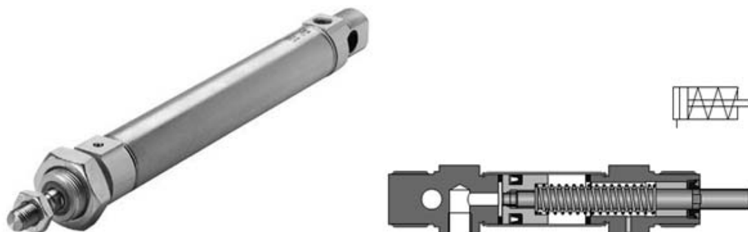
Рисунок 5.1 – Пневматический цилиндр одностороннего действия с пружинным возвратом
