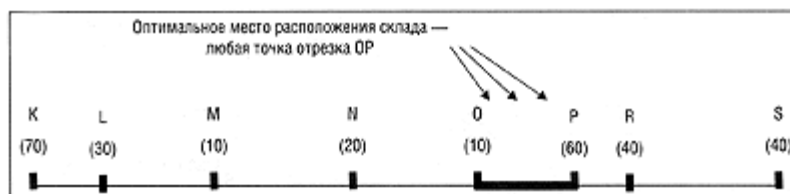
Рисунок 3.3 – Определение оптимального расположения склада при равенстве левого и правого грузооборотов пробной точки
