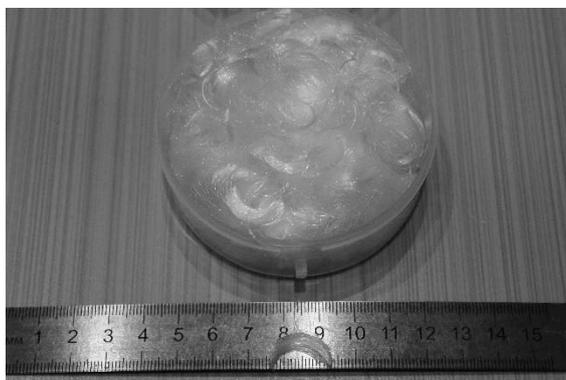
Рис. 1. Полипропиленовая фибра для изготовления опытных образцов
