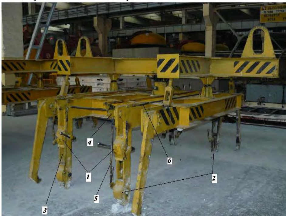
Рис. 5. Усовершенствованное ГЗУ для технологической оснастки
