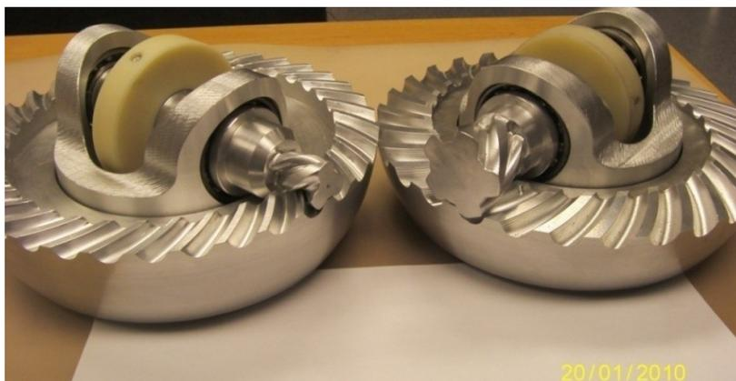
Рис. 2. Макеты конических редукторов с ExSyGear зацеплением
