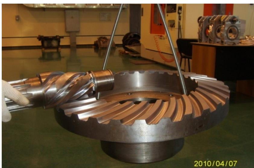
Рис. 4. Детали конического редуктора с ExSyGear зацеплением для подземного электровоза (изделие 2)
