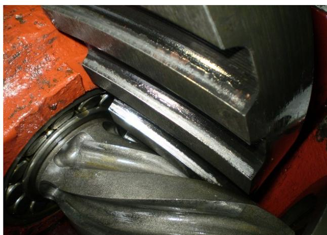
Рис. 5. Положение пятна контакта в ExSyGear зацеплении
