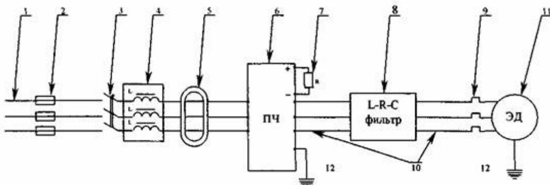
Рис. 1. Функциональная схема частотно-регулируемого привода: 1 – кабель сети, 2 – сетевые предохранители, 3 – автоматический выключатель, 4 – сетевой дроссель, 5 – фильтр радиопомех, 6 – преобразователь частоты, 7 – тормозной резистор, 8 – синус (L-R-C) фильтр, 9 – тепловое реле, 10 – кабель двигателя, 11 – асинхронный двигатель с короткозамкнутым ротором, 12 – заземление
