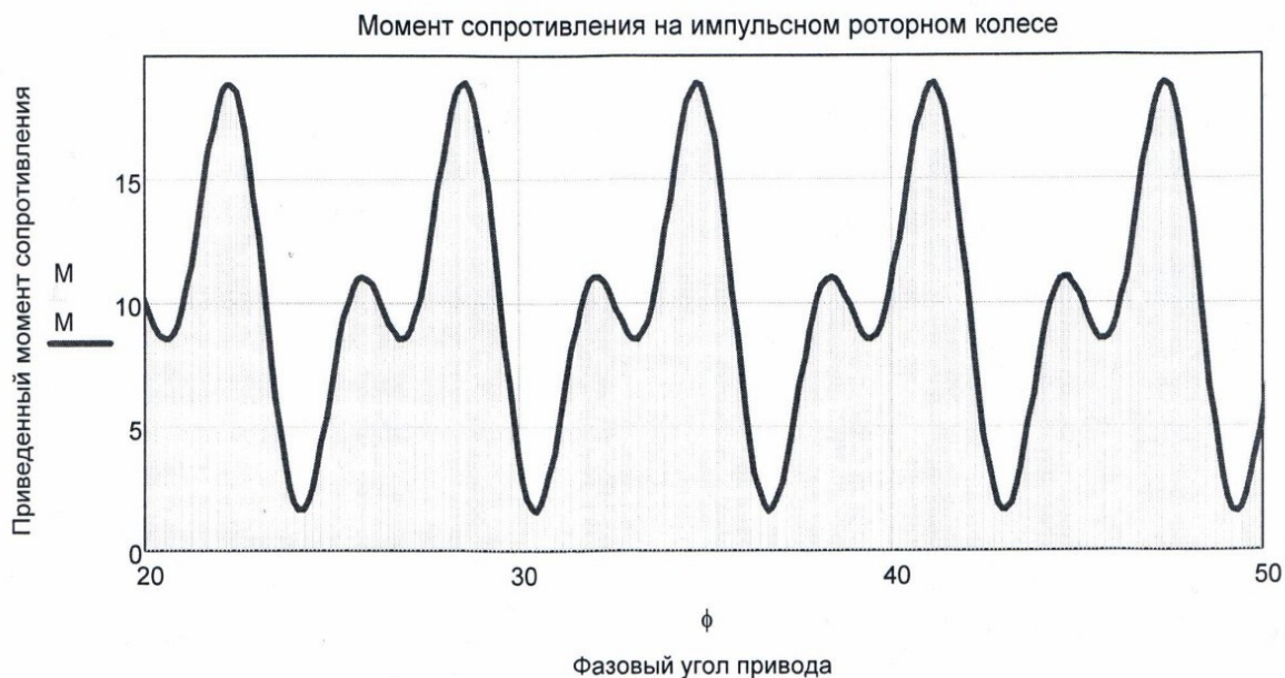
Рис. 2. Момент сопротивления при использовании импульсного привода
