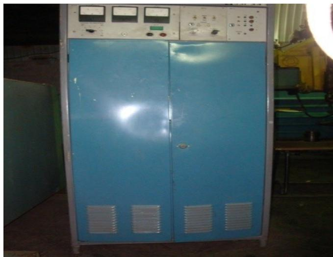
Рис. 1. Ультразвуковой генератор УЗГ 3-4
