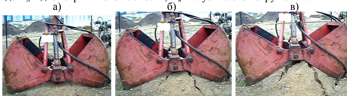
Рис. 2. Характерные этапы разработки грунта грейфером с винтовым якорем: а – нагружение массива грунта винтовым якорем; б – разрушение массива якорем; в – захват оторванного кома грунта и разработка ослабленного массива
