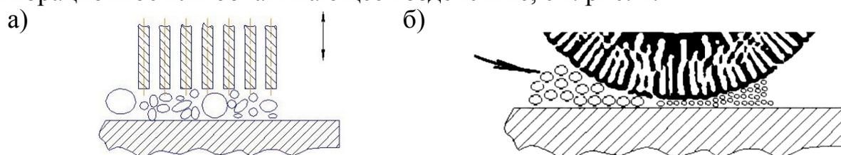
Рис. 1. Механизмы разрушения в штифтовых мельницах: а) разрушение ударно-вибрационным действием; б) разрушение обкатывающим действием
