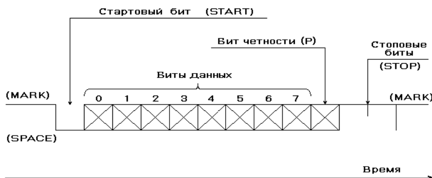
Рисунок 13.1 – Формат передачи данных интерфейса RS-232
