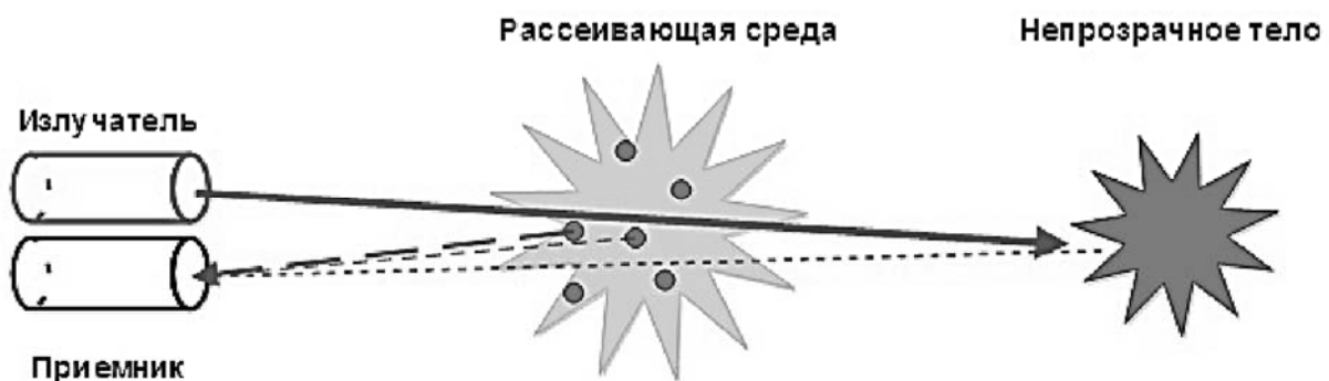
Рисунок 9.4 – Принцип действия лидара
