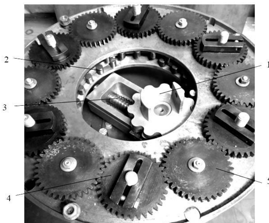
Рис. 10. Макет передачи с силовым замыканием сателлита и секторов ЦЗК
