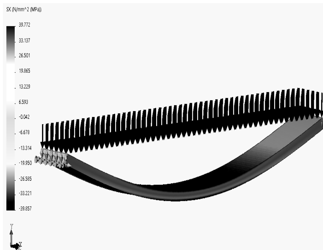
Рис. 11. Эпюра распределения нормальных напряжений в пластине со сферическими выемками, расположенными в шахматном порядке
