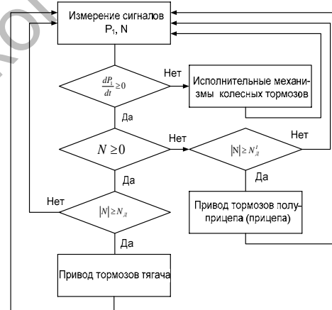
Рисунок 8 – Алгоритм управления торможением седельного автопоезда
