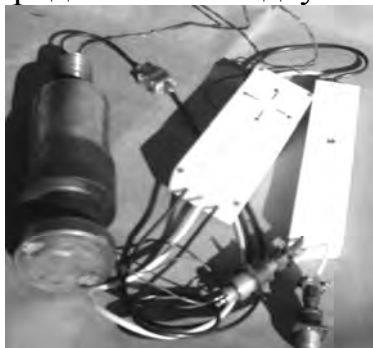
Рисунок 10 – Устройство измерения сил в шкворне АТС МАЗ и электронные блоки обработки информации
