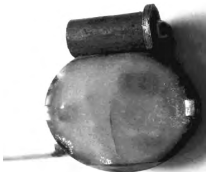
Рисунок 11 – Датчик измерения сил в опоре колодок тормоза
