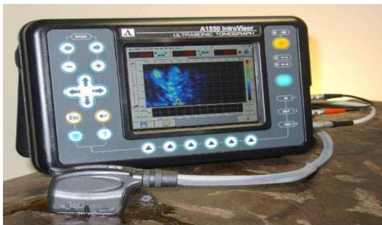
Рис. 3. Ультразвуковой томограф A1550 IntroVisor
