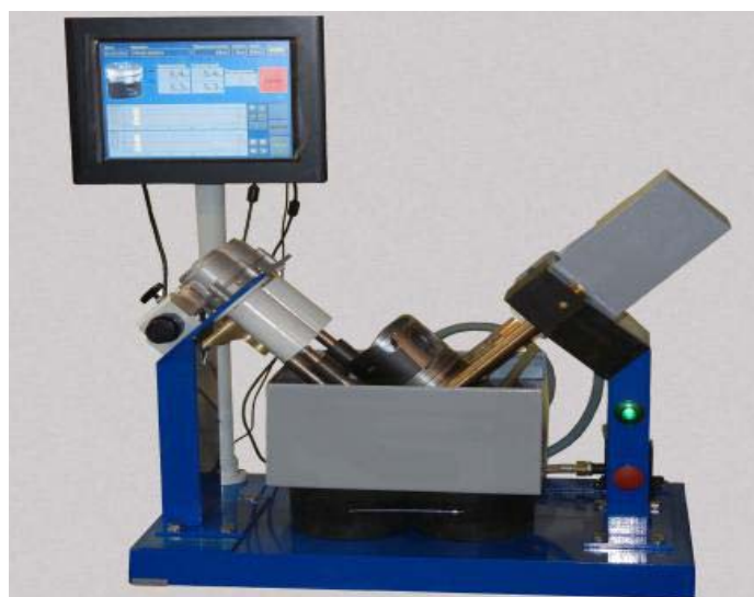
Рис. 1. Установка для неразрушающего контроля качества сцепления нирезистивных вставок в поршнях дизельных двигателей
