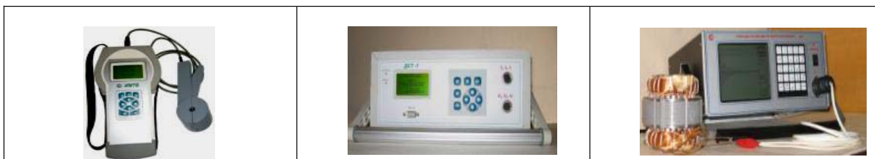
Рис. 10. Приборы для диагностики электроэнергетического оборудования ИМТБ (а); ДСТ (б) и ДО-1 (в)
