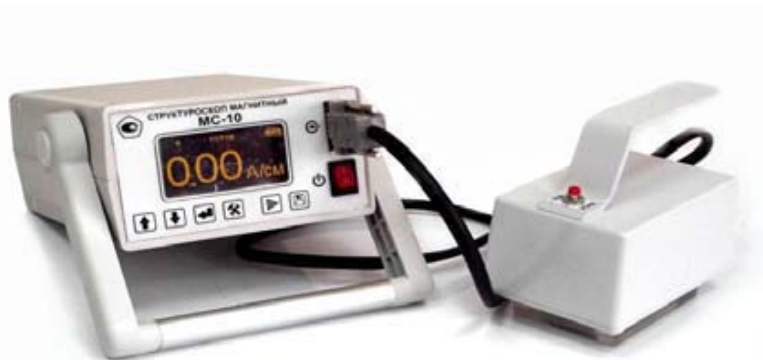
Рис. 5. Магнитный структуроскоп МС-10
