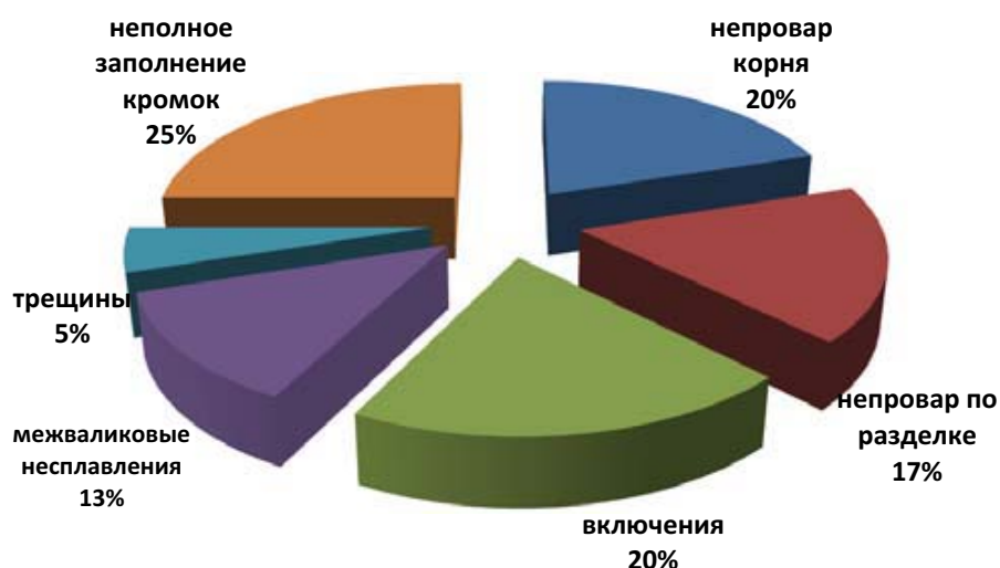
Рис. 5. Классификация дефектов обнаруженных при ДДК по типам
