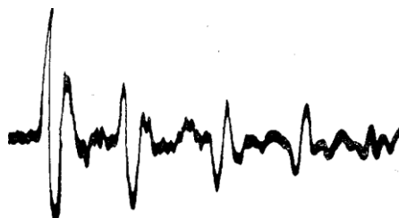
Рис. 2. Осциллограмма ряда отраженных сигналов частотой 50 кГц, длительностью в один период, полученных в изделии из стеклопластика толщиной 40 см
