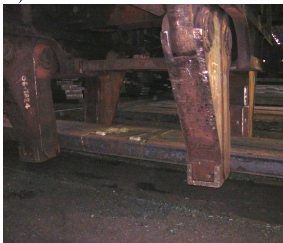
Рис. 1. Схема (а) и вид (б) нагружения промышленной заготовки: 1 – заготовка; 2 – захваты нагружающего устройства; 3 – преобразователи АЭ
