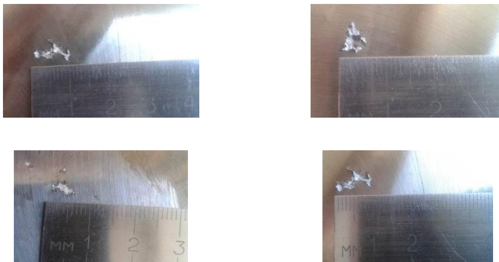
Рис. 2. Шлаковые включения в стальной отливке после вскрытия
