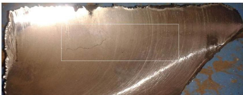
Рис. 3. Обнаруженная в образце внутренняя трещина на глубине 6 мм
