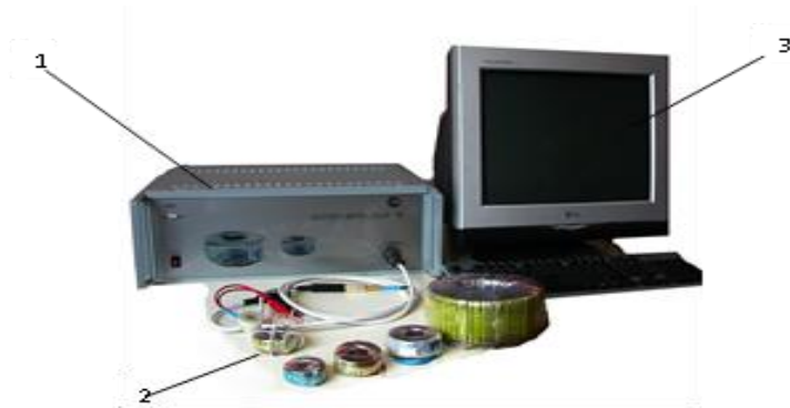
Рис. 1. Общий вид диагностического прибора ТВ: 1 – электронный блок; 2 – гибкая измерительная катушка и контролируемый тороидальный трансформатор; 3 – ЭВМ
