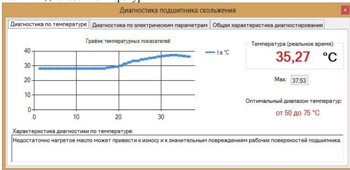
Рис. 1. Диагностика подшипника скольжения по температуре
