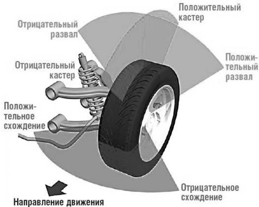
Рисунок 8.6 – Углы установки управляемых колес автомобиля
