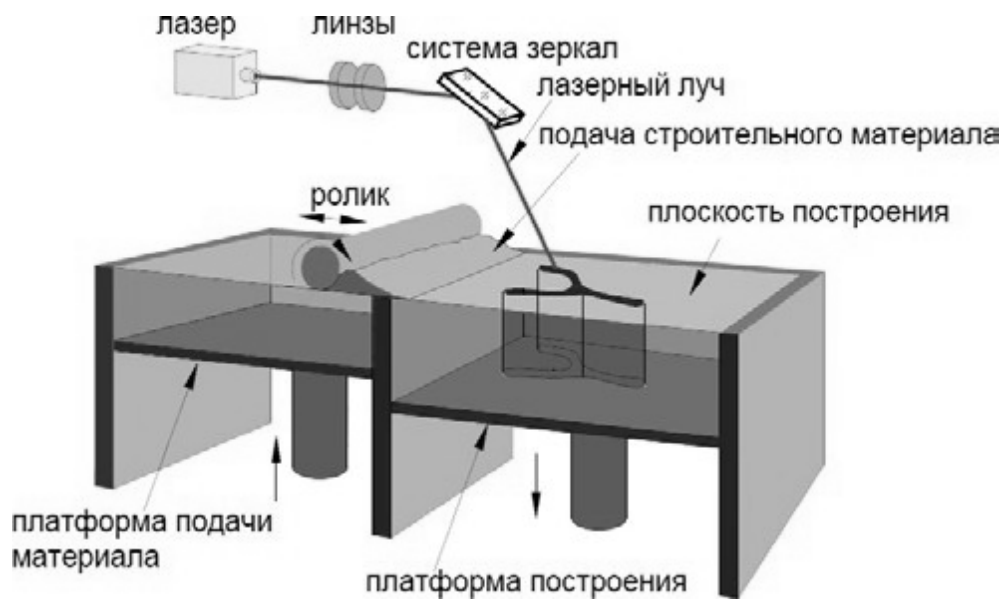
Рисунок 2 – Послойное нанесение порошка
