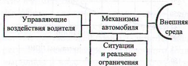
Рис. 1. Функциональная модель адаптивной системы управления режимами автомобиля
