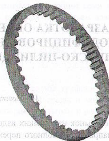
Рис. 1. Твердотельная модель центрального колеса с внутренними зубьями эвольвентного профиля
