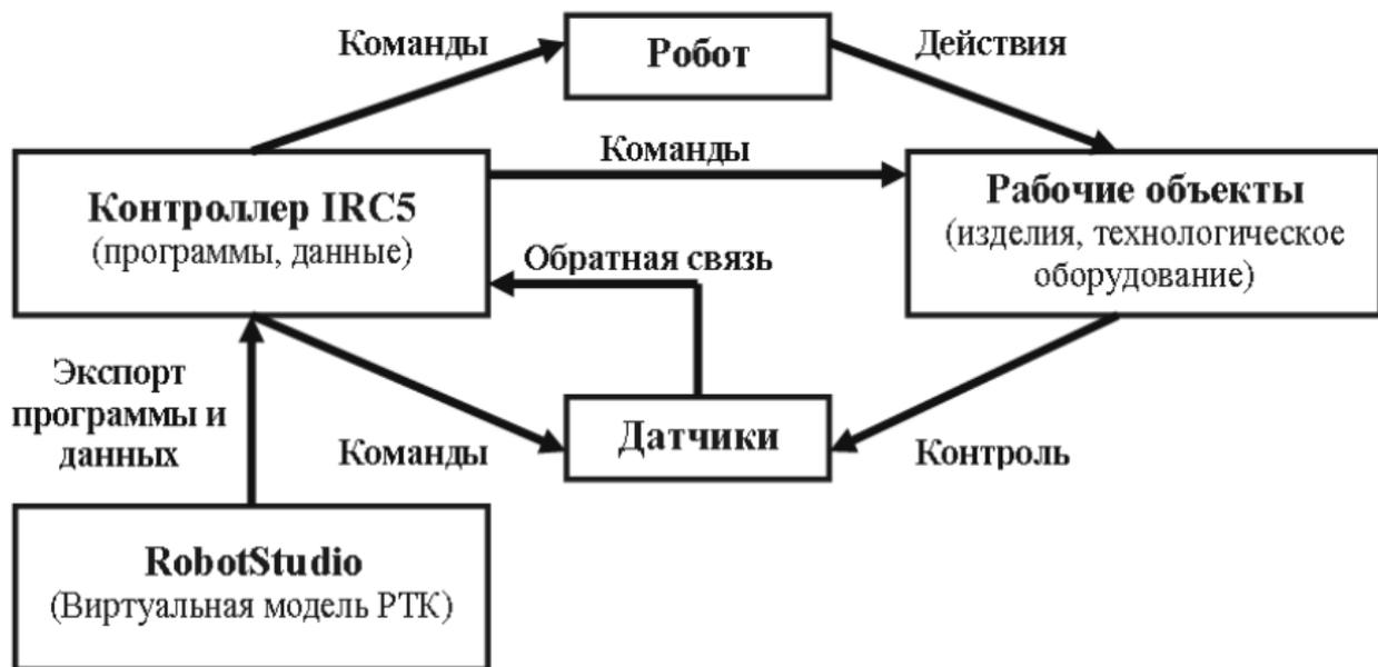
Рисунок 3.1 – Схема взаимодействия основных компонентов РТК
