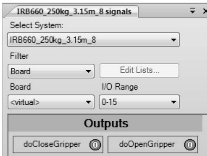
Рисунок 3.6 – Окно моделирования сигналов для портов ввода-вывода контроллера робота
