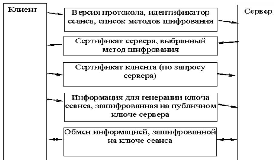
Рисунок 8.1 – Обобщенная схема установки соединения по протоколу SSL
