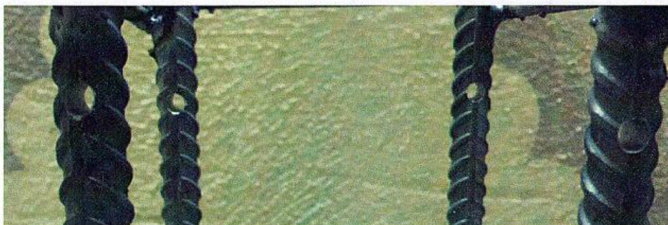
Рисунок 4. – Отверстия диаметром 5 мм в продольной арматуре
