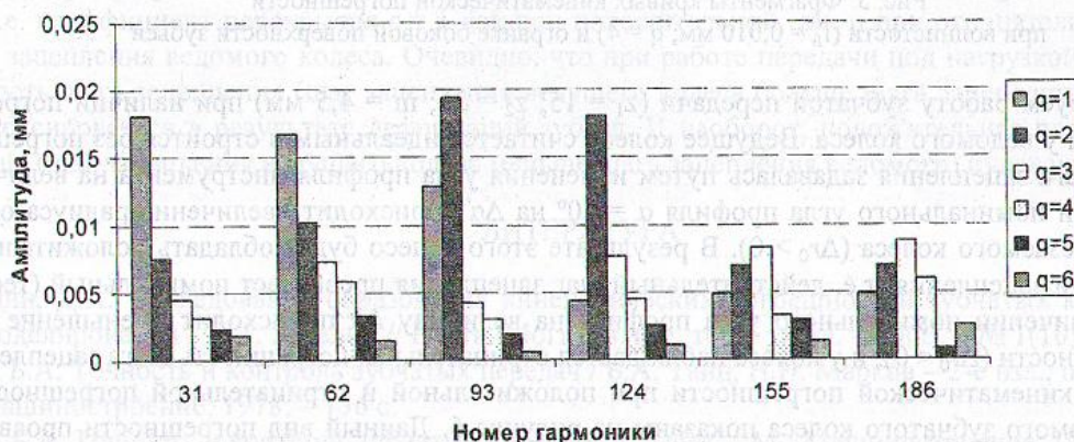
Рис. 4. Зубцовая и кратные ей составляющие спектра при волнистости боковой поверхности зубьев ( z_1 = 15 ; z_2 = 31 ; f_{fr} = \pm 0,030 мм)
